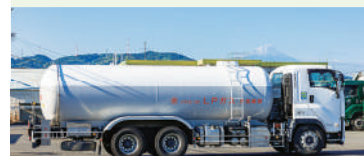
タンクローリー (LPガス)
